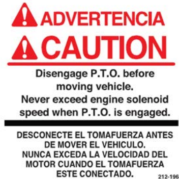
Figure 22. Caution: Disengage P.T.O., PN 212-1968
