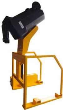
**D6035** Montage stationnaire, déversement jusqu'à une hauteur de 60", incluant pompe avec au choix alimentation électrique 110v, 220v ou 460v. Compatible avec bacs de type américain à 2 barres de 120 - 360 litres (32 - 96 gallons US).
