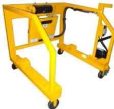
**D6043** Montage stationnaire, déversement jusqu'à une hauteur de 45", incluant pompe avec au choix alimentation électrique 110v, 220v ou 460v. Compatible avec bacs de type américain à 2 barres de 120 - 360 litres (32 - 96 gallons US). Options disponibles: roulettes, contrôle avec bouton poussoir électrique, contrôle à distance.
