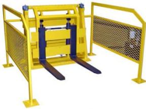
**D74900** Montage stationnaire, déversement jusqu'à une hauteur de 35", incluant pompe avec au choix alimentation électrique 110v, 220v ou 460v. Compatible avec bacs à pochettes.
