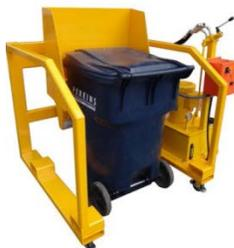
**D6042** Montage stationnaire, déversement jusqu'à une hauteur de 52", incluant pompe avec au choix alimentation électrique 110v, 220v ou 460v. Compatible avec bacs de type américain à 2 barres de 120 - 360 litres (32 - 96 gallons US). Options disponibles: roulettes, contrôle avec bouton poussoir électrique, contrôle à distance.
