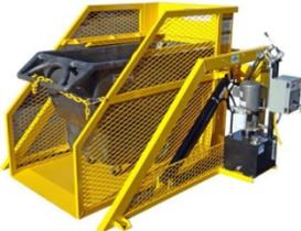
**D7650** Montage stationnaire, déversement jusqu'à une hauteur de 29", incluant pompe avec au choix alimentation électrique 110v, 220v ou 460v. Compatible avec bacs Rubbermaid 1315. Options disponibles: contrôle avec bouton poussoir électrique, contrôle à distance.
