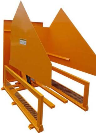
**D7415** Montage stationnaire, peut être modifié pour accommoder des bacs personnalisés. Le poids estimé des bacs pleins est de 225 - 275 kg (500 - 600 lbs) Débit hydraulique de + / - 3 gpm avec valve de surpression régularisée à 1800 psi requis pour opération.
