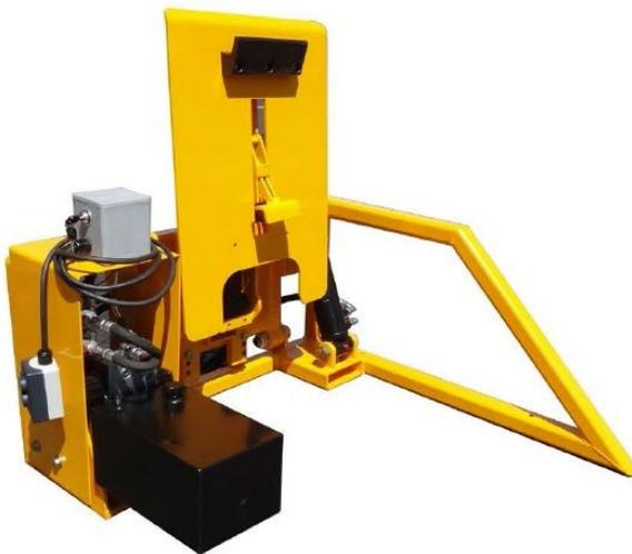
La série de verseurs industriels pour déchets alimentaires est conçue pour vider des bacs et des conteneurs contenant un grand volume de déchets liquides. Le déversement se fait sans pertes ni éclaboussures laissant la zone et le bac propres. La demande pour ces verseurs a augmenté depuis quelques années. Gardez votre environnement de travail propre et gardez les déchets dans leur bac.
