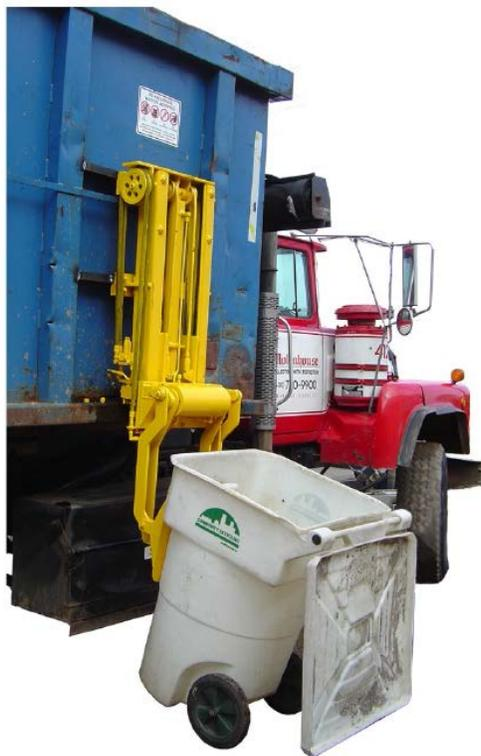
Le système de levage vertical D7905 permet une hauteur de déversement avec la moitié de l'espace pour l'installation du verseur ou de l'espace hydraulique. PERKINS a utilisé ce verseur vertical d'inspiration monte charge dans plusieurs applications. Même si PERKINS offre des versions multiples du D7905, le verseur peut être modifié pour rencontrer vos spécifications.
