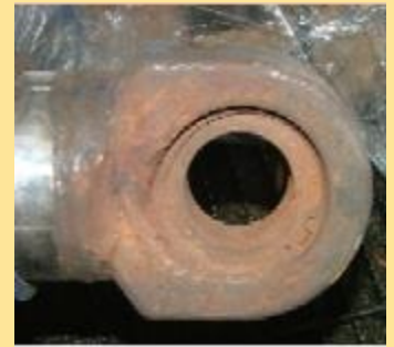
Bague pivotante saisie par manque de lubrification
