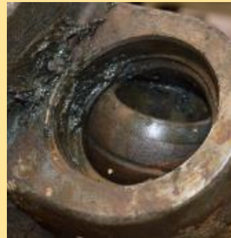
Bout de tige avec bague manquante
