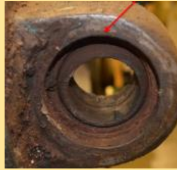
Bague pivotante saisie par manque de lubrification
