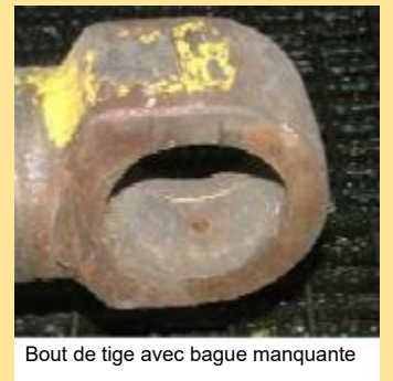
Bague pivotante saisie par manque de lubrification
